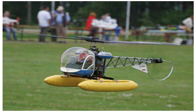
Alte Bell 47 G von Graupner, umgebaut auf Elektroantrieb
