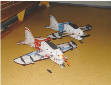
So werden jetzt die Indoorflieger mit dünnem EPP mit Kohlestangen verstärkt gebaut. Dadurch sind sie robust und trotzdem sehr leicht.
