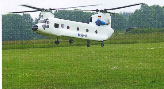
Auch meine Chinook musste wieder ran. Zur Erinnerung: ein kompletter Eigenbau mit Holzblättern und Flightcontroller.
